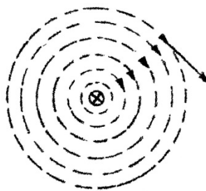
Fig. 5,6. Magnetisch veld bij een stroomvoerende rechte geleider.
