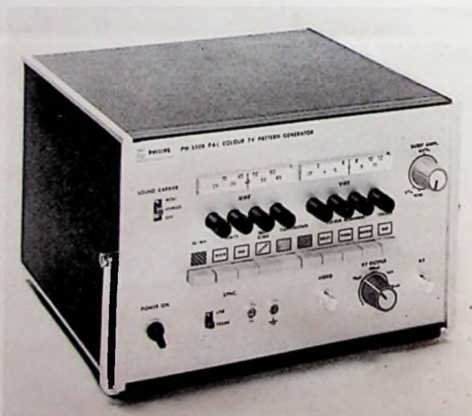
E. De Philips service-kleurenoscillator voor het PAL-systeem. Ook hier een video-uitgang en een HF-uitgang voor alle CCIR-TV-banden. De afstemming geschiedt met behulp van druktoetsen. De HF-uitgangsverzwakker is gecalibreerd. (Foto Philips).
